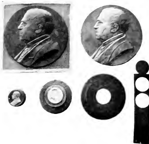
Fig. 7. — Wasmodel — bronzen model, machinaal verkleinde poinsoen, en gereede inwaartsche stempel der voorzijde van den Dr. Kuyperpenning, door J. J. van Goor. Tevens daarompassende ring, om verschuiven van penningmetaal en de stempel der keerzijde te voorkomen, en metalen reep met daaruit gestooten schijf.
